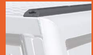
Zwei C-Schienen auf dem Dach
