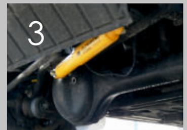
Auflastung bis 3,5 t mit Luftfederfahrwerk in Verbindung mit 5 cm Höherlegung, Räder mit höherer Traglast, Lenkungsdämpfer
