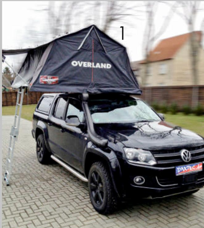
Fahrwerk + 35 mm, Ansaugschnorchel,
