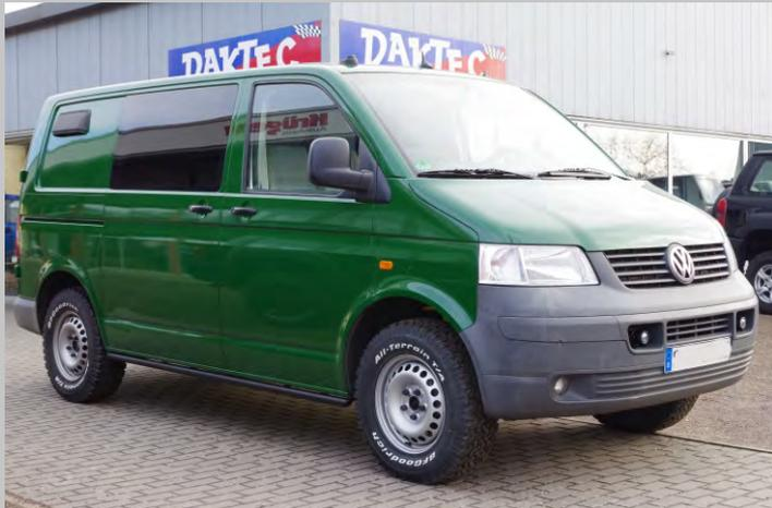
**Höherlegungsfahrwerk, Geländereifen, Unterfahrschutz in 6 mm Alu, Schwellerrohre, Ausrüstung mit HELLA Xenon DE Fernscheinwerfern, Fahrzeugfolierung uvm.**
