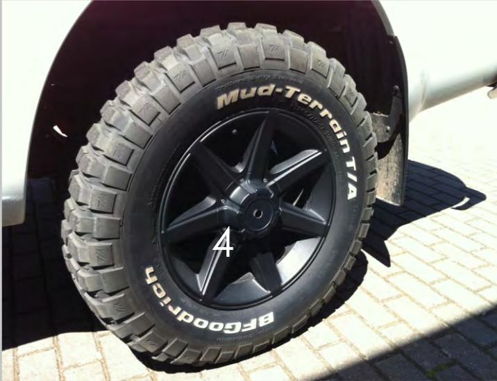
Auflastung bis 3,5 t mit EFS-Fahrwerk in Verbindung mit 5 cm Höherlegung, Räder mit höherer Traglast, Lenkungsdämpfer
