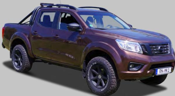
Fahrwerkshöherlegung +3,5 cm,Bodyliftkit + 8cm und Auflastung auf 3,5 Tonnen
