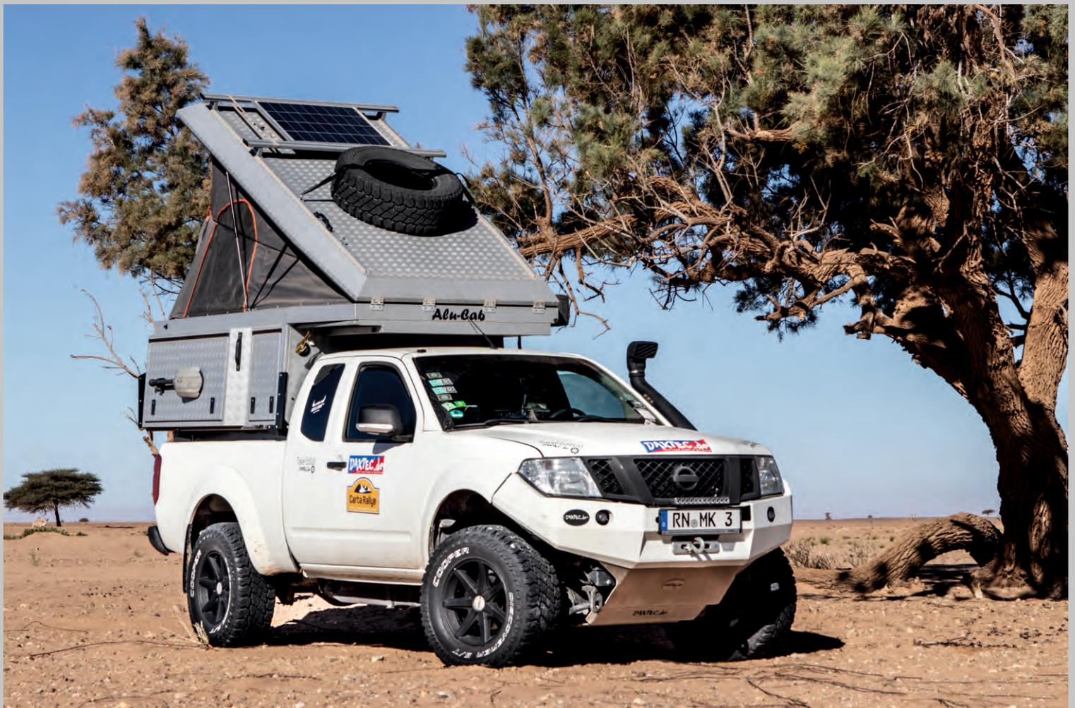
+80 mm Bodylift, + 50 mm DAKTEC-Fahrwerk, Rad/Reifen Kombination 285/70 R17, Unterfahrschutze 6 mm Alu, Xenonscheinwerfer von Hella für die Stoßstange, LED-Balken von LASER, 5,4 t Seilwinde in der Frontstoßstange, Ansaug-Schnorchel, wahlweise mit Alu-Hardtop/Dachzelt oder Wohnkabine. Schubladensystem, Kühlbox, Solarpaneel, Standheizung, Küche und vieles mehr.
