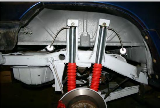
Umbau und Modifikation von Fahrzeugen jeder Art für den Einsatz im Rallyesport. Käfigbau, Doppeldämpfersysteme, Fahrwerke, Tanksysteme und mehr.. der DAKTEC Pajero „EVO“, erfolgreich auf allen Veranstaltungen national und international.
