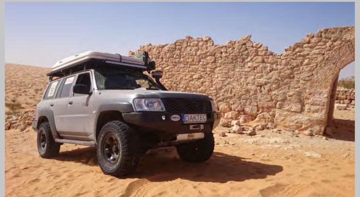
NISSAN Patrol mit 5,4 t Front-Seilwinde, Front & Heck-Stoßstange, Ansaugschnorchel und 50 mm Höherlegungs-fahrwerk für schweren Einsatz.
