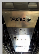
Unterfahrschutz aus 6 mm Aluminium
