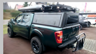
Fahrwerkshöherlegung +3,5 cm,Bodyliftkit + 8cm und Auflastung auf 3,5 Tonnen
