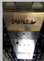
Unterfahrschutz aus 6 mm Aluminium
