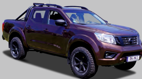
Fahrwerkshöherlegung +3,5 cm,Bodyliftkit + 8cm und Auflastung auf 3,5 Tonnen
